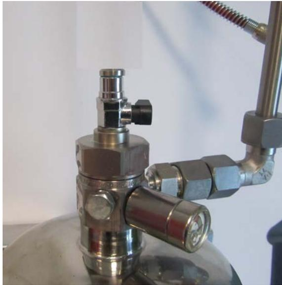
Cylindres de 6, 9,5, Tuyauterie AISI 304 12 mm
