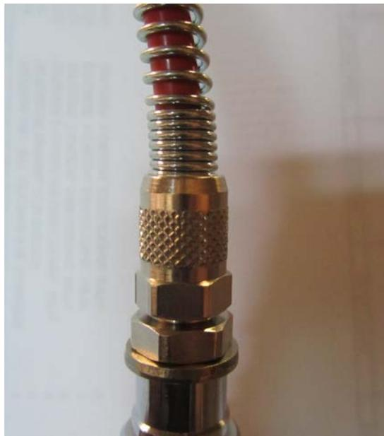
16. L'ensemble final de ligne avec manomètre doit s'installer de façon à ce que le manomètre soit accessible pour la pressurisation du tube et vérification postérieure de sa charge.
