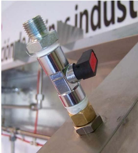
Utilisez un adaptateur qui s'adapte à l'entrée de pressurisation et fait pression l'obus, pour permettre l'entrée du gaz.
