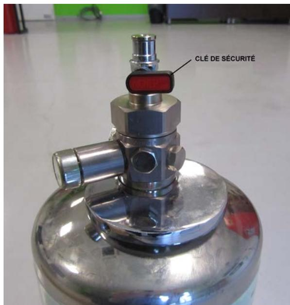
3. L'agent extingueur est pressurisé à 17 bars. Le cylindre dispose de 2 sorties pour la connexion de la tuyauterie d'extinction, marquées sur l'image comme 1 et 2. Sélectionner la sortie la plus convenante selon la position de l'installation du cylindre.
