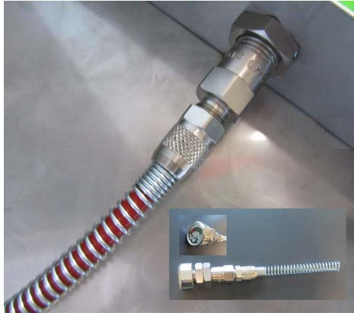
En dévissant le manomètre l'entrée de pressurisation du tube de détection devient accessible.
